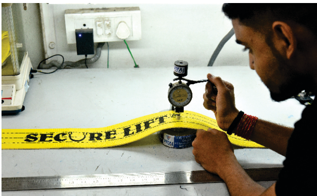
Thickness Gauge (0-10 mm & LC 0.01 mm)
